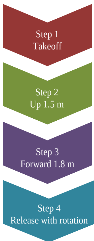
図 11 飛行制御のフローチャート
