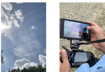
ドローンを使用した送電線点検の様子
