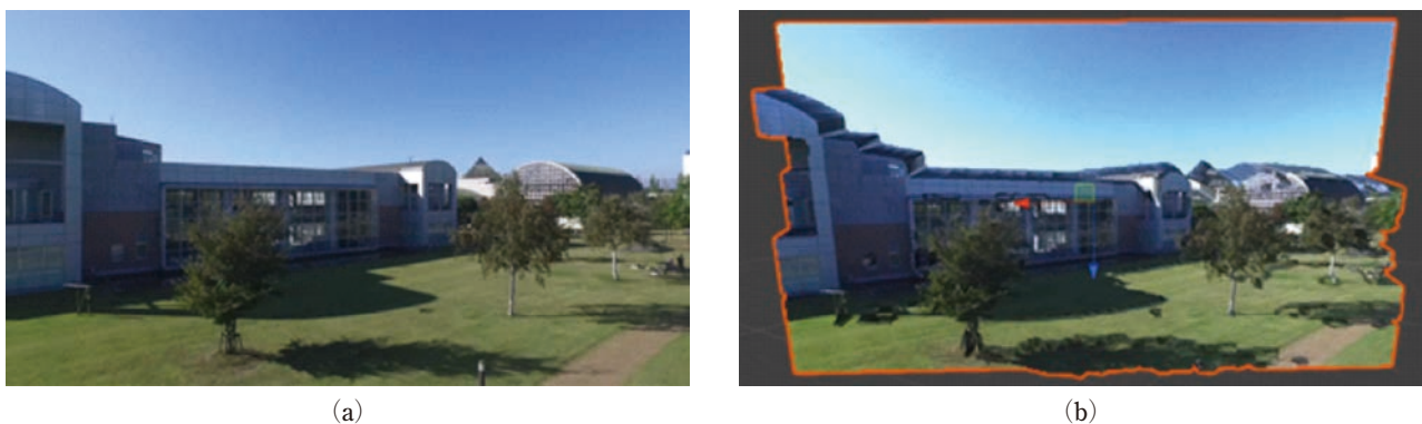
図 5 ドローンを移動体として、大学公園風景を対象物として撮影した動画の 1 フレーム画像を図 5-(a) に示す。そのフレームとその 1 時刻前のフレームの 2 枚の画像から再構成された 1 枚の 3D 画像を 3D viewer でみるときのスナップ画像を図 5-(b) に示す。
