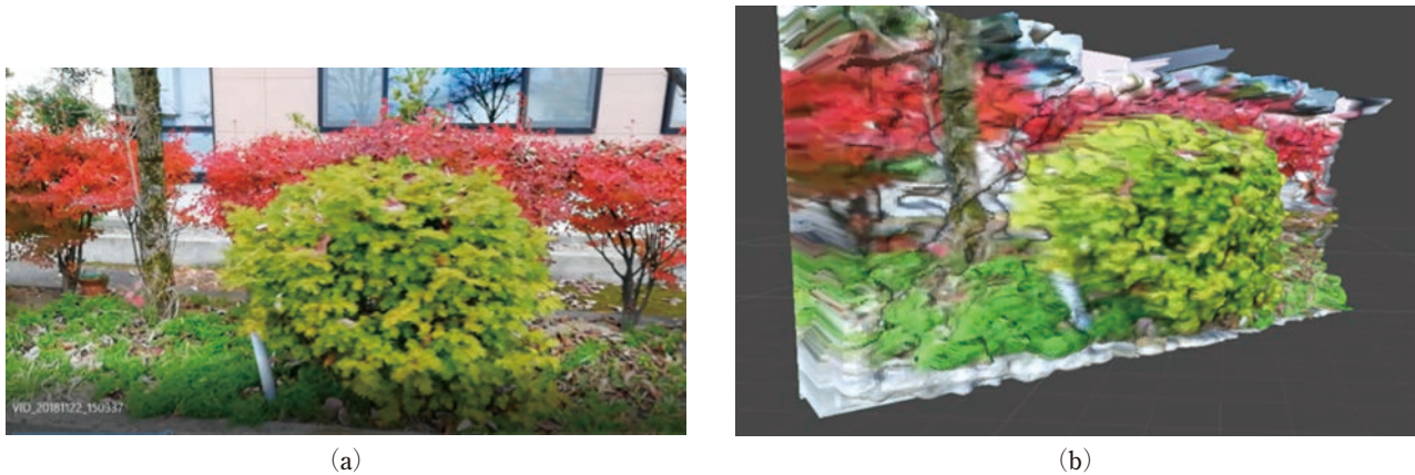
図 4 人間を移動体として、花や木を対象物として撮影した動画の 1 フレーム画像（図 4-(a)）である。そのフレームとその 1 時刻前のフレーム画像の 2 枚の画像から再構成された 1 枚の 3D 画像を 3D viewer でみたものである（図 4-(b)）。
