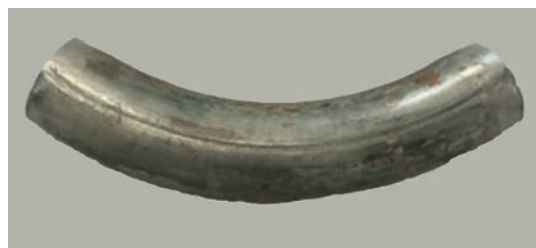
図4 DRF 後の温間押し曲げ加工を行った丸棒
