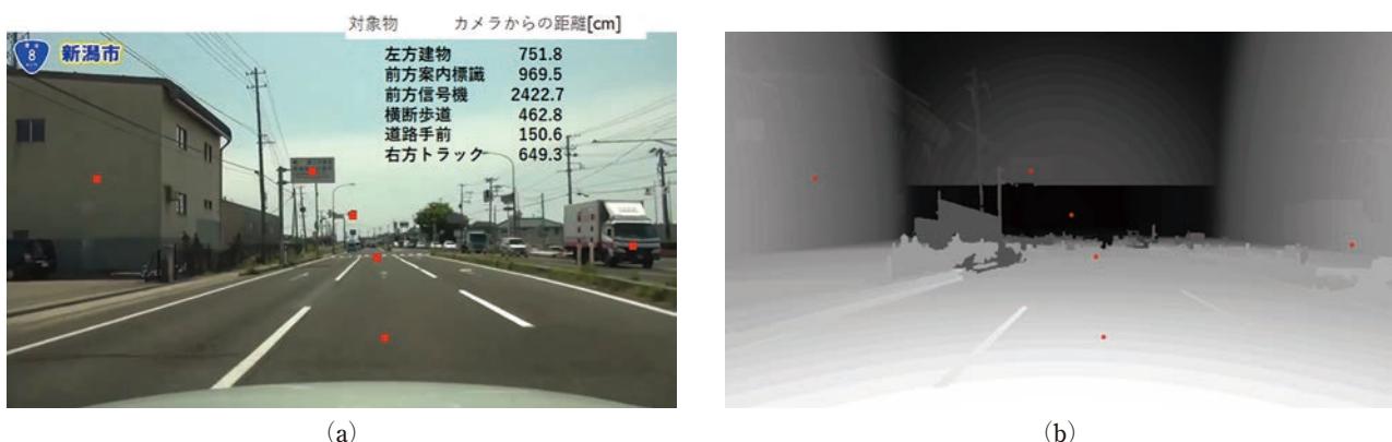
図9 車載カメラからの動画像の1つのフレーム画像の6つのサンプル pixel の位置を赤の四角で示し、この6つのサンプル pixel において検出されたカメラからの距離を cm 単位で示す(図9-(a))。図9-(a)の6つのサンプル点におけるカメラからの距離値は、図9-(a)の画像のすべての pixel において検出された距離値の明暗画像表示である図9-(b)の赤い四角のサンプル点のものである。
