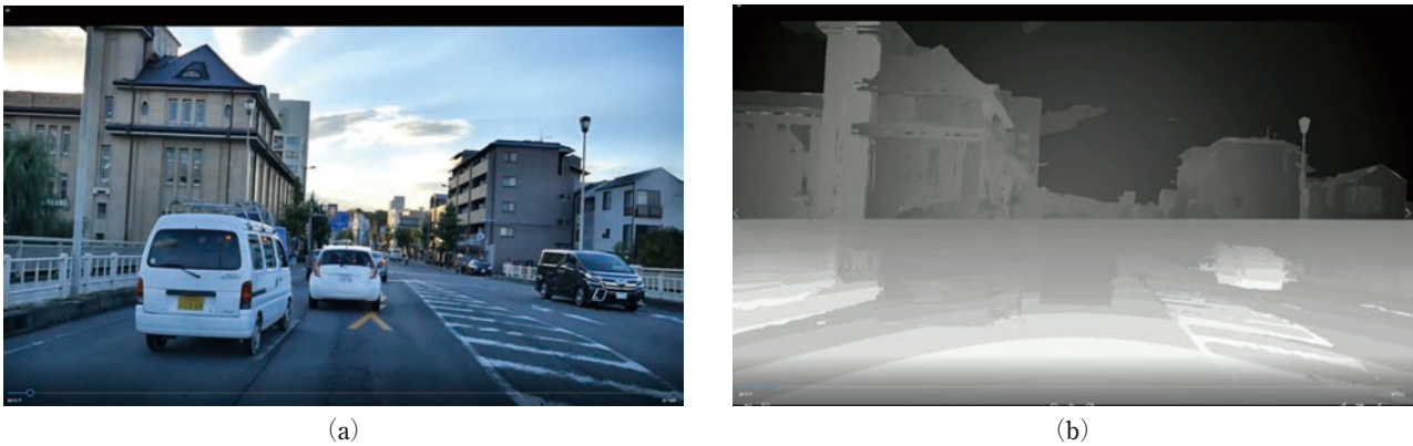
図7 車載カメラにおけるビデオ画像中の1つのフレームのRGB画像(図7-(a))と、その画面に対応する全画素の距離画像(図7-(b))を示す(明るいほど車載カメラに近いことを示している)。2つの画像間では、全ピクセルが対応している。
