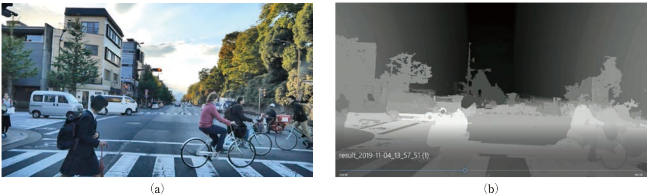
図8 移動体である車が停止した場合の動画の1フレーム画像(図8-(a))とその1フレーム前の画像によって得られる距離画像の1フレーム画像(図8-(b))を示す。
