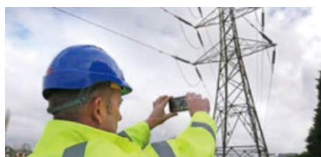
図4 スマホによる3次元計測
