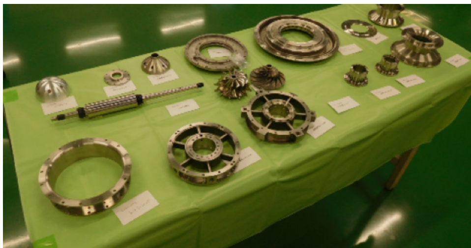
図9 30 kW 級ガスタービン発電機主要部品
