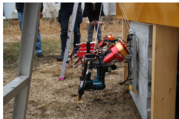
図14 子機のドリル作業実証実験
